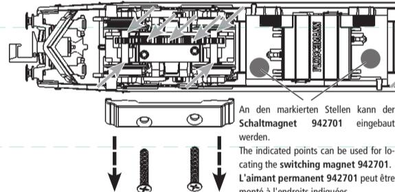
An den markierten Stellen kann der Schaltmagnet 942701 eingebaut werden.
